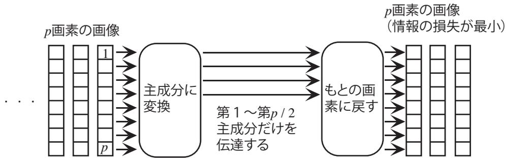
図 5: KL 変換による画像データの圧縮
