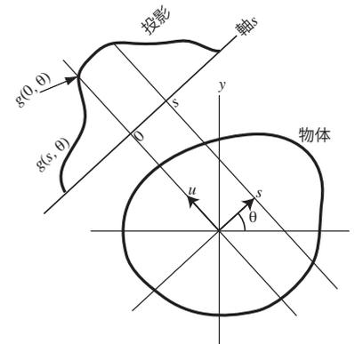
ある方向からX線を照射し、その方向での吸収率 (投影) を調べる
