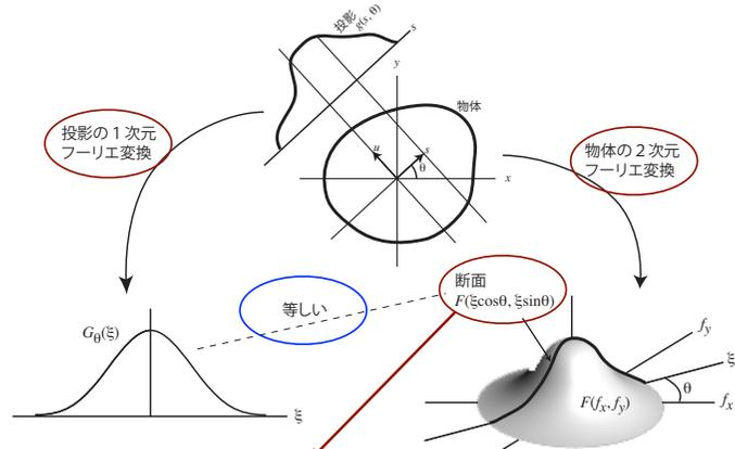
「断面」がすべてそろえば、2次元逆フーリエ変換で2次元関数が再構成できる
