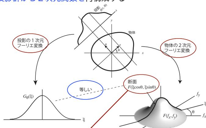
「断面」がすべてそろえば、2次元逆フーリエ変換で2次元関数が再構成できる
