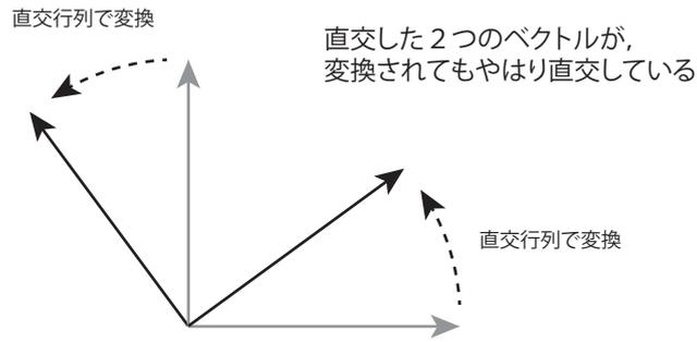
図 2: 直交行列によるベクトルの変換.
