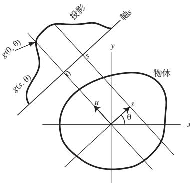
ある方向からX線を照射し、その方向での
