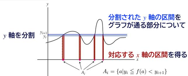
$y_i \times (A_i \text{ のルベーク測度})$  を求める
