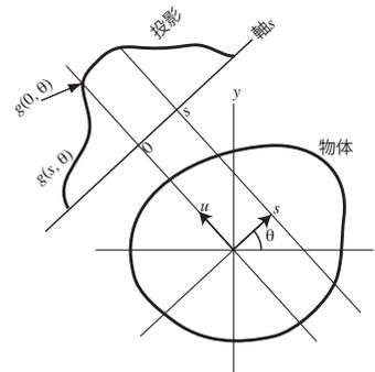
ある方向からX線を照射し、その方向での吸収率(投影)を調べる
