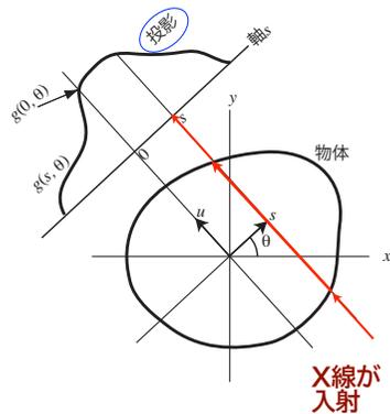
X線がある直線に沿って物体を通過するとき、直線上の各点で吸収される
